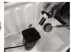
Извлеките ротор из насосной станции и очистите водой и щеткой
