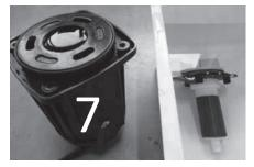
Установите насосную станцию в вертикальное положение и залейте мягким средством для удаления известкового налета (например, чистящим уксусом). Погрузите ротор в пластиковую миску /контейнер, наполненный тем же средством от известковой накипи, и оставьте на 24 часа. Через 24 часа смойте водой и снова соберите насос.
