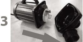
Выверните винты из насосной станции
