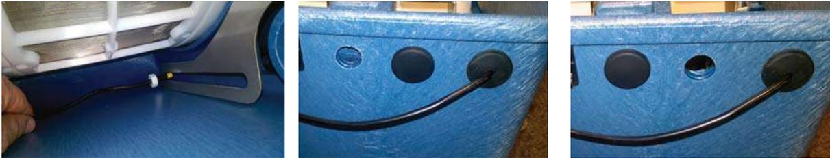
Протолкните разъем через монтажный кронштейн во впускной камере. Пожалуйста, имейте в виду, что переключатель уровня должен быть повернут на 180 градусов относительно положения фильтра. Затем наденьте гайку на разъем и прикрутите ее к выключателю уровня.
