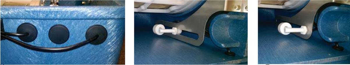
Извлеките резиновую заглушку из корпуса и вытяните разъем переключателя уровня. Протолкните разъем через резиновую пробку, чтобы он был свободен.
