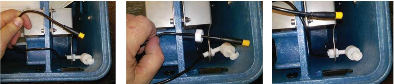
Протолкните разъем через отверстие и протолкните его через резиновую пробку. Маленькое отверстие пробки можно расширить острым ножом, чтобы сделать это немного легче. Вставьте вилку в среднее отверстие.
