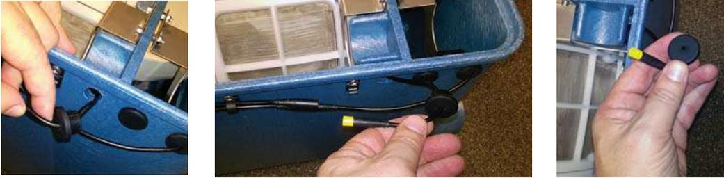
Снимите переключатель уровня с камеры барабана, взяв гайку и соединитель через монтажный кронштейн. Снимите глухую пробку с середины и вставьте ее в левое отверстие.
